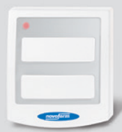
Funk-Innentaster Signal 111 2-Kanal, 433 MHz, KeeLoq-Wechselcode zur Steuerung von 2 Antrieben oder 1 Antrieb und 1 Außenbeleuchtung, aus UV-beständigem Material
