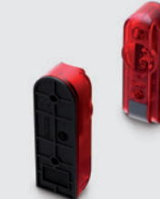
Einweg-Lichtschranke Extra 626 • 20-28 V, IP 50, 2-Draht • Reichweite 8 m • Geeignet für: Novomatic 423 563 S NovoPort®
